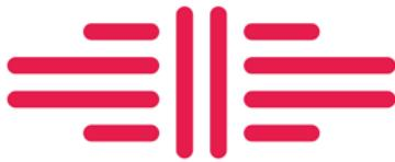
**CUANDO** medido en los dos ángulos de rotación 1 = 0° vertical (orientación y) y 2 = 90° horizontal (orientación x), los materiales que tienen coeficientes de retrorreflexión que difieren en más del 15% se definen como **SENSIBLE A LA ORIENTACIÓN**.
